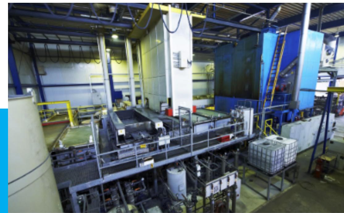
Der KTL-Prozess besteht aus 14 Bädern in Folge
